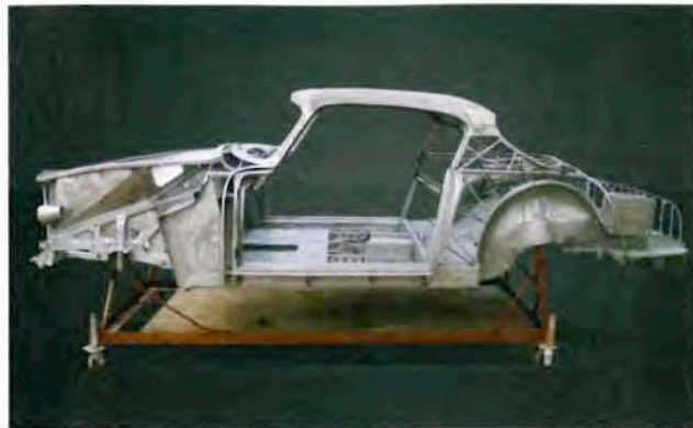
Kompletter Aufbau ohne Kompromisse - Rahmen und Skelett eines Alfa Romeo 1900 CSS der dritten Serie
